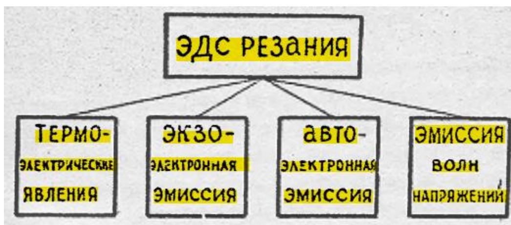
Рис. 1. Причины генерирования электрических сигналов при резании.
