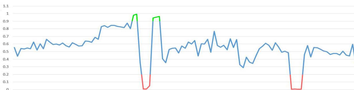
Рис. 7. Перепады сигналов при вращении головы человека наверх и вниз. Зеленым цветом выделен поворот головы наверх, красным – вниз
