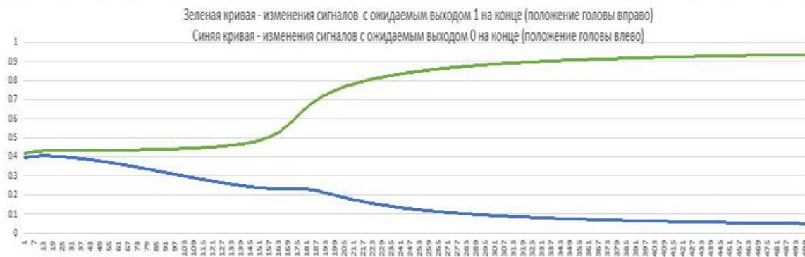
Рис. 1. Изменение сигналов на выходе в зависимости от количества эпох. Зеленая кривая сигналы положения головы вправо, синяя – влево
