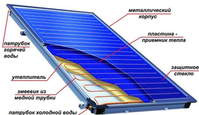
Рис. 2. Плоский солнечный коллектор
