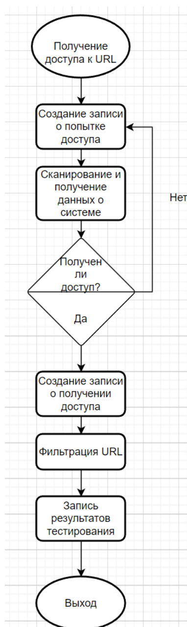
Рис. 6. Блок-схема модуля веб-сканера
