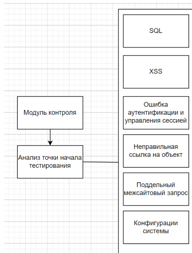
Рис. 7. Структура внедрения системы проникновения в систему безопасности
