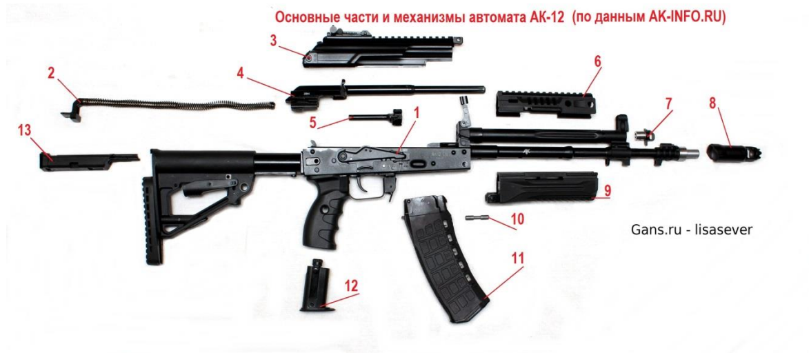
Рис. 1. Основные части и механизмы автомата АК-12.
