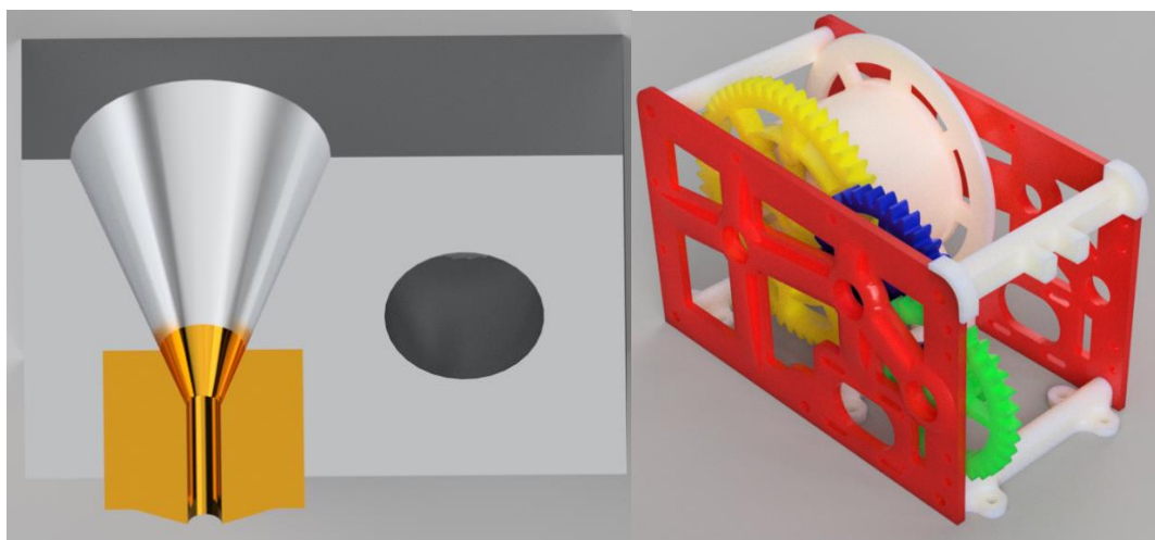
Рис. 3. Модифицированный нагревательный блок и модель редуктора
