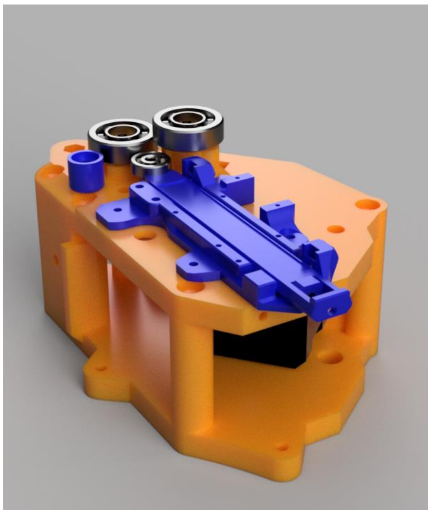
Рис. 1. Модель устройства для нарезки бутылки
