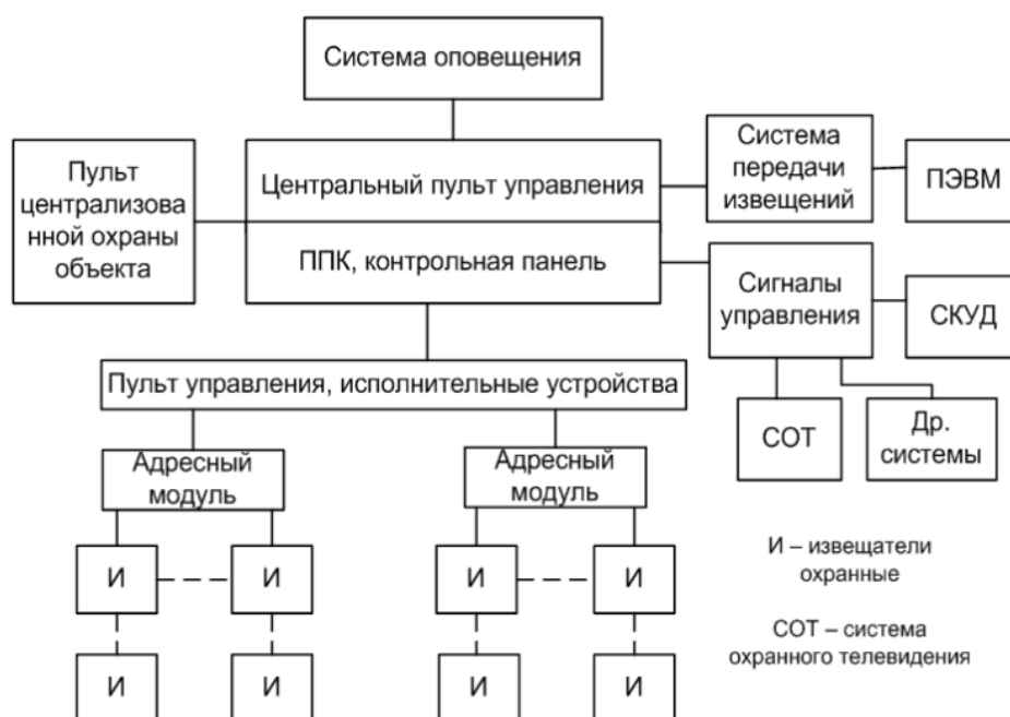
Рис. 2. Типовая структура системы охранной сигнализации
