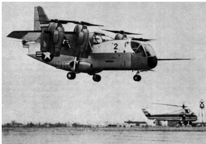
Рис. 3. Четырехдвигательный XC-142A фирм «Хиллер», «Райан» и «Воут» с крылом в положении, соответствующем вертикальному взлету
