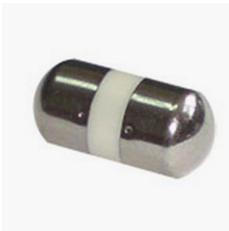
Рис. 2. Корпус автономного электростимулятора желудочно-кишечного тракта
