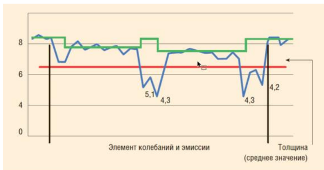
Рис. 1. Определение мест утончения стенки трубы [5]
