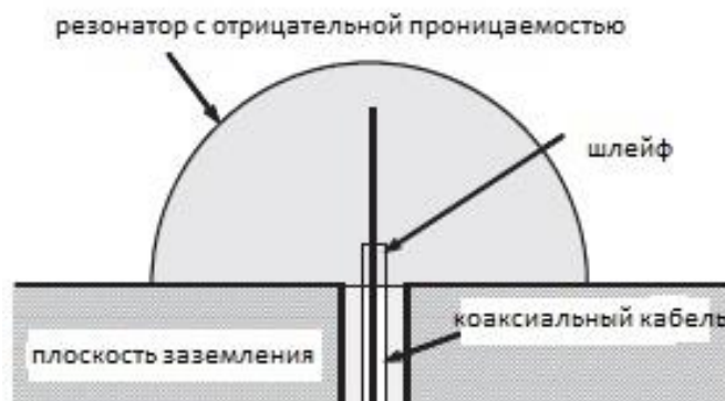
Рис. 9. Пример небольшой антенны, нагруженной метаматериалом (отрицательная диэлектрическая проницаемость) [5-7]
