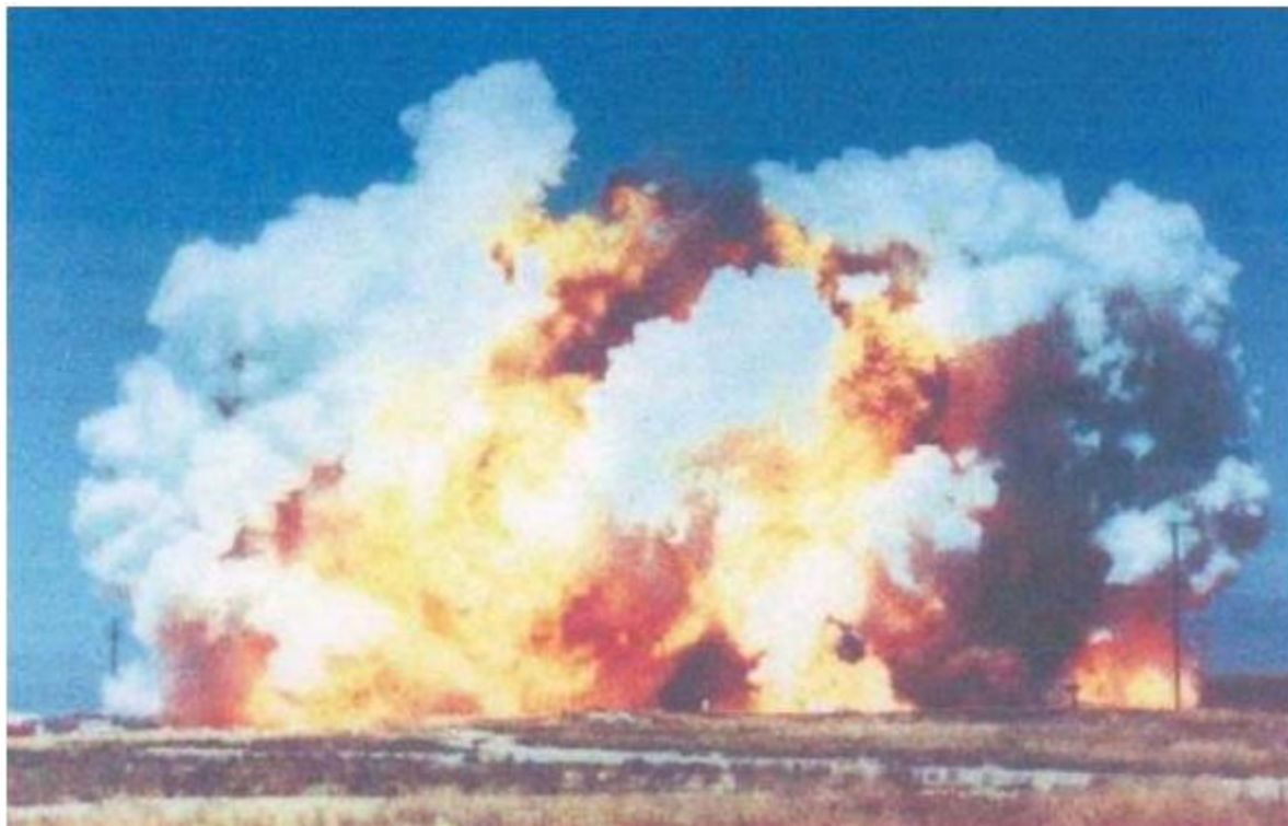
Рис. 1. Столб пламени, возникший в результате разлива СПГ в воду
