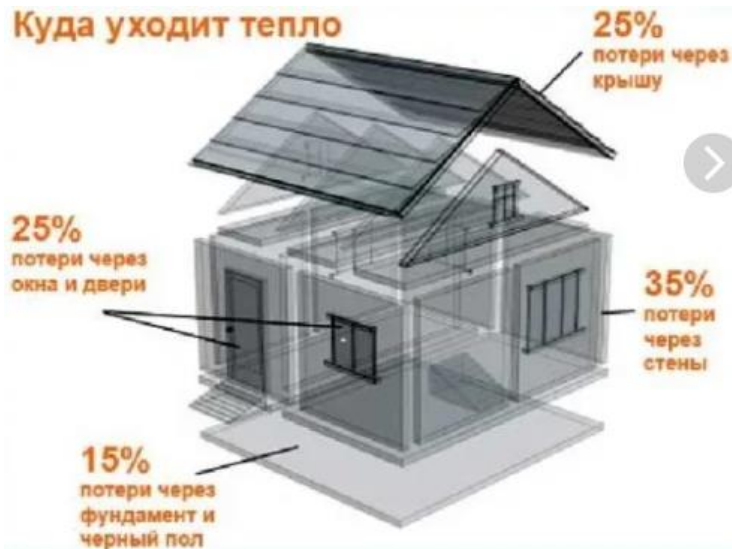
Рис. 1. Потери тепла через ограждающие конструкции здания
