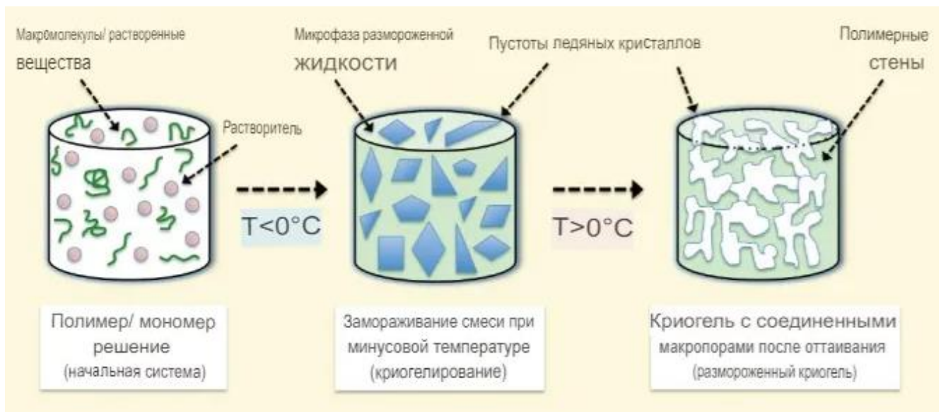
Рис. 7. Основные этапы образования макропористых каркасов криогелей [16]
