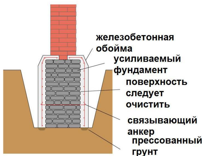
Рис. 2. Усиление фундамента железобетонной обоймой
