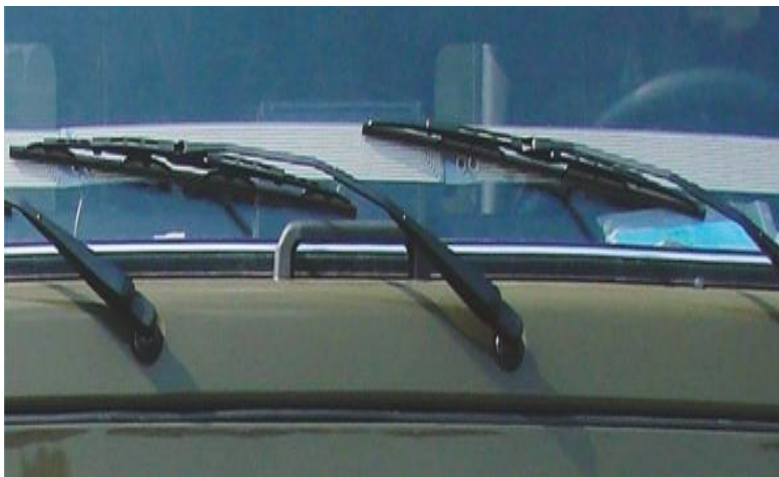
Рис. 2. Подогрев зоны щеток стеклоочистителя
