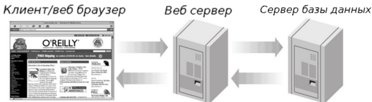
Рис. 2. Трехуровневая архитектура, в которой веб-браузер запрашивает ресурс, а ответ генерируется из базы данных
