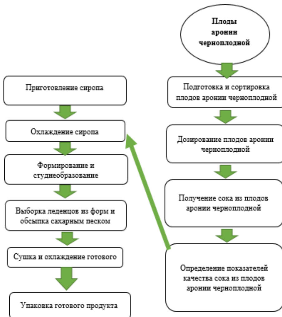
Рис. 1. Схема технологических стадий получения профилактических леденцов на основе сока плодов аронии черноплодной
