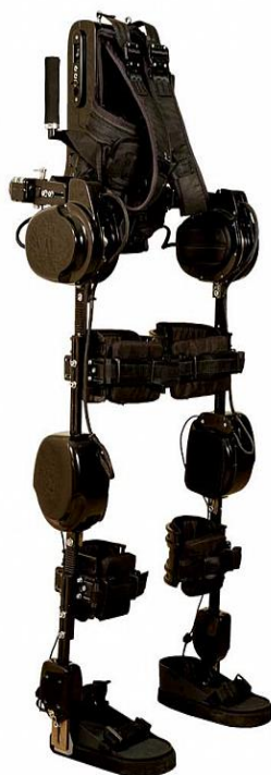
Рис. 2. Модель стационарного активного экзоскелета нижних конечностей
