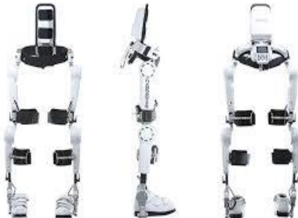
Рис. 1. Модель портативного активного экзоскелета нижних конечностей
