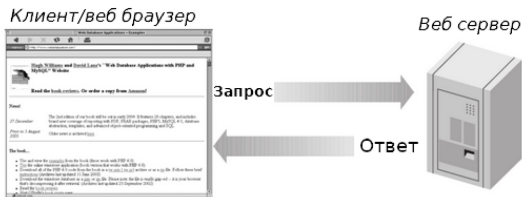
Рис. 1. Двухуровневая архитектура, в которой веб-браузер делает запрос, а веб-сервер отвечает
