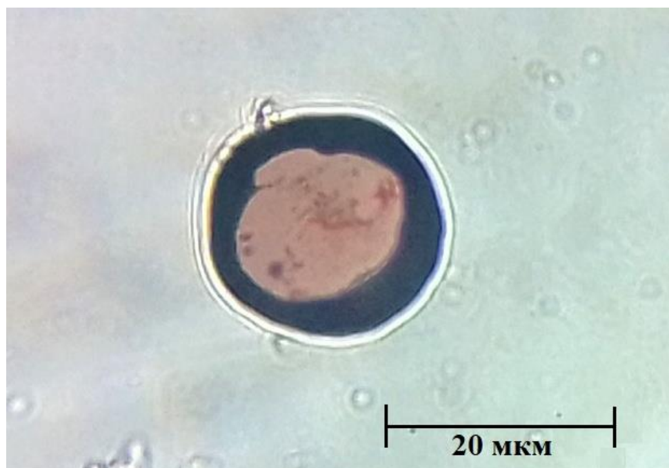
Рис. 4. Микрофотография конгломерата из наночастиц меди, полученного в 0,5% растворе крахмала. Увеличение \times 3000
