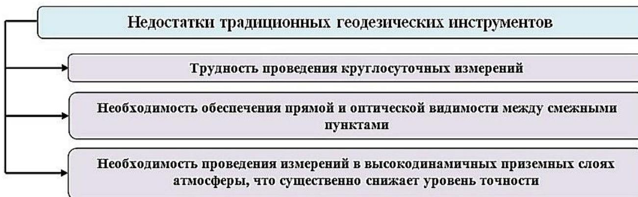
Рис. 3. Недостатки традиционных геодезических инструментов
