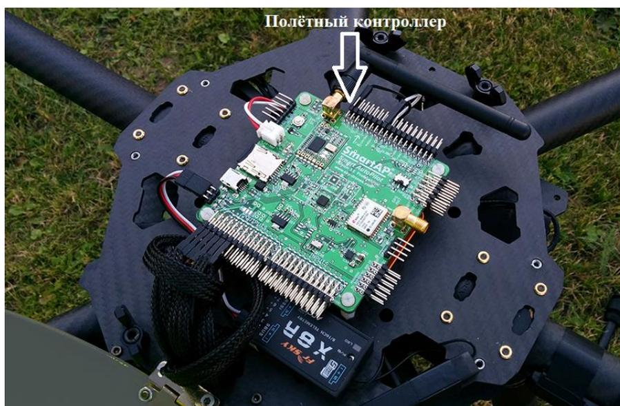
Рис. 3. Внешний вид и расположение полётного контроллера
