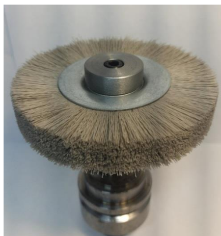
Рис. 2. Дисковая абразивная щетка в оправке универсально – заточного станка с ЧПУ
