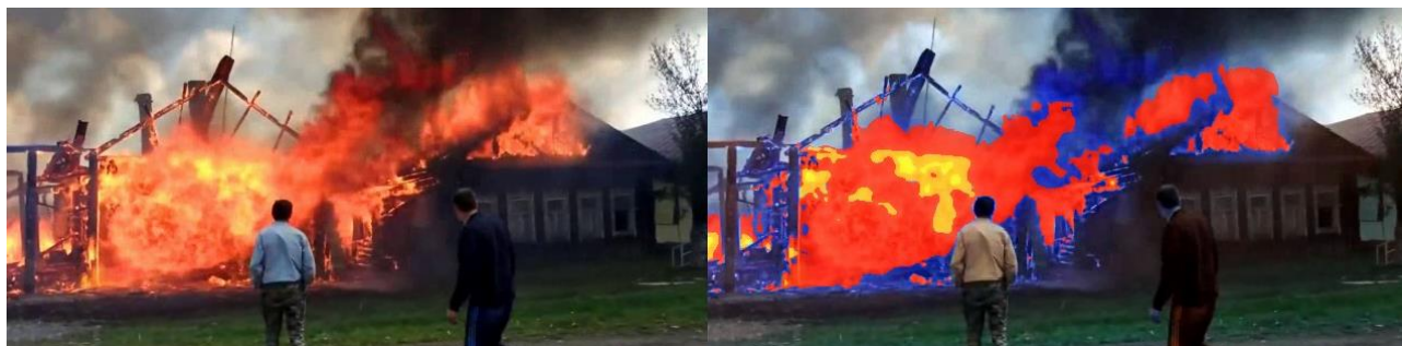
Рис. 2. Демонстрация работы U-Net. Сегментирование пламени
