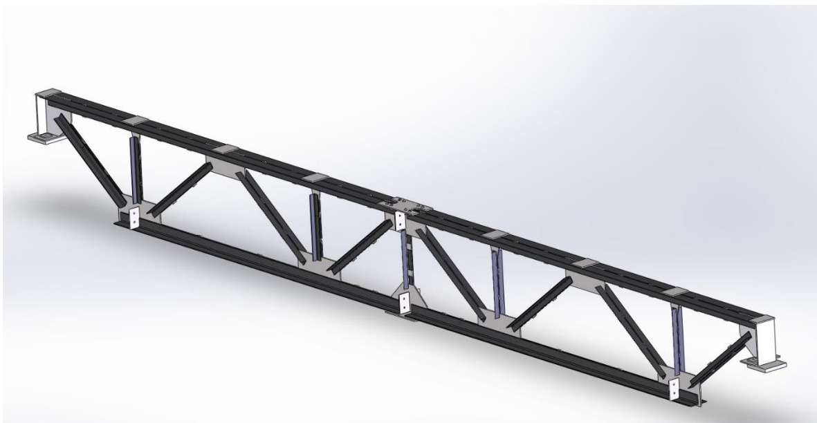
Рис. 1. Наглядное изображение металлической фермы
