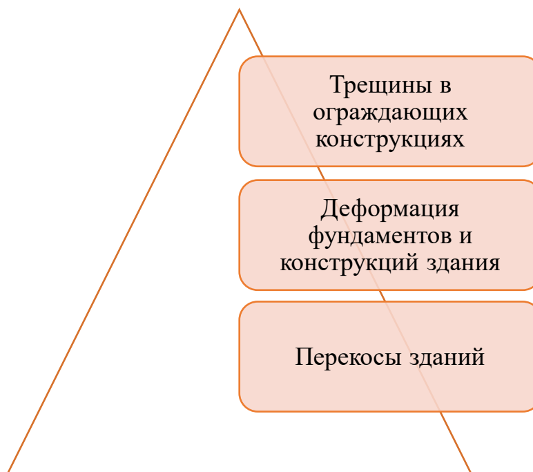
Рис. 2. Дефекты от воздействия на основание зданий
