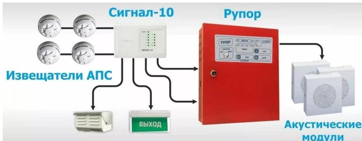
Рис. 3. Схема системы оповещения
