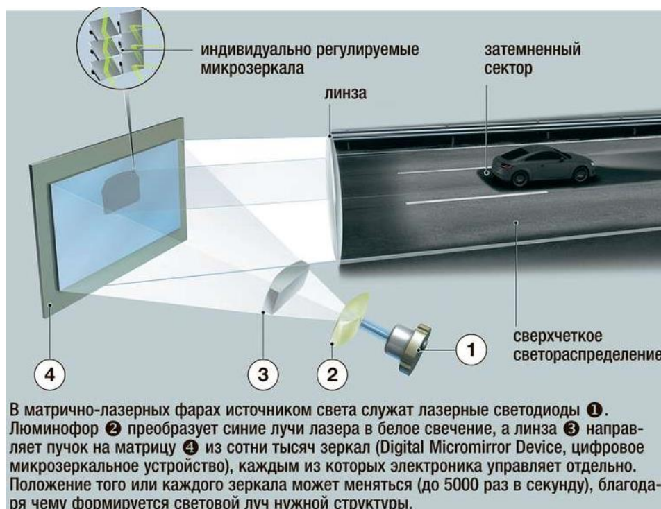
Рис. 2. Устройство матрично-лазерной фары
