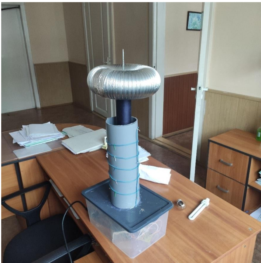
Рис. 2. Высокочастотный трансформатор Николы Тесла
