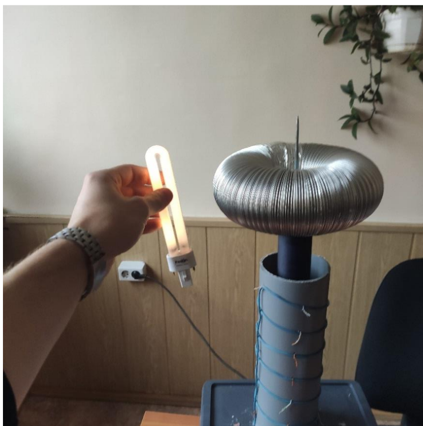
Рис. 3. Наглядное действие электромагнитного поля трансформатора
