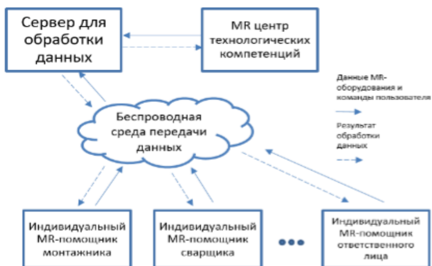
Рис. 8. Структура информационно-управляющей системы с использованием MR-тренажеров
