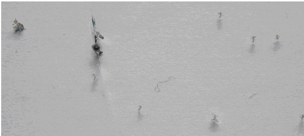
Рис. 7. Пробои стеклянной пластины толщиной 3 мм
