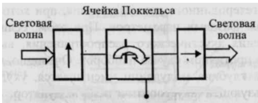
Рис. 1. Принцип измерения напряжения, основанный на эффекте Поккельса
