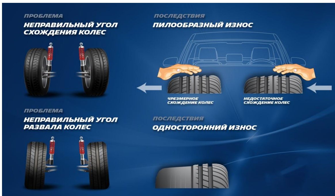
Рис. 3. Влияние угла развала схождения на износ шин
