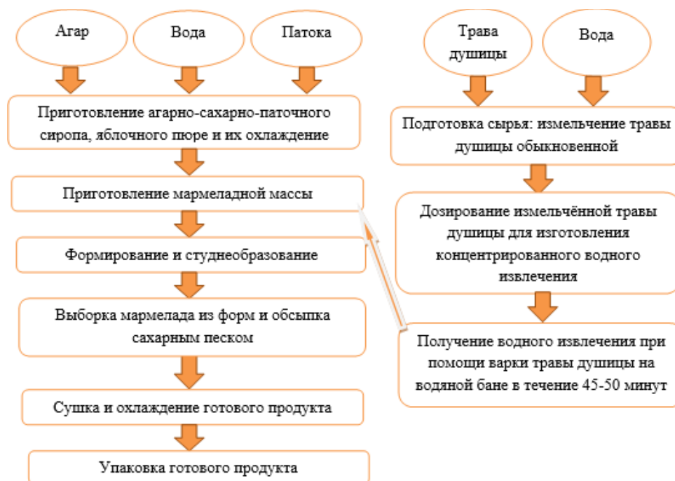
Рис. 1. Схема технологических стадий получения мармелада, обогащённого экстрактом травы душицы обыкновенной
