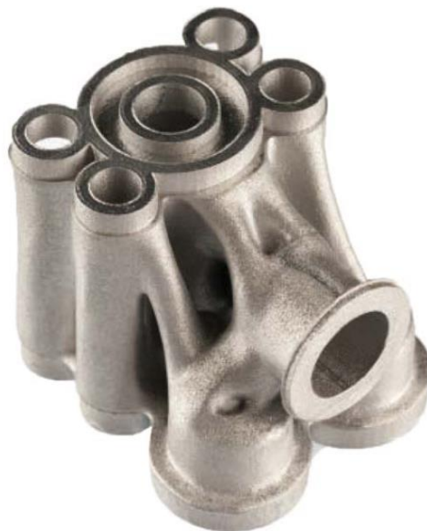
Рис. 2. 3-D печатный металлический гидравлический блок устраняет утечки, вызванные повышением давления при повороте каналов жидкости на 90 градусов
