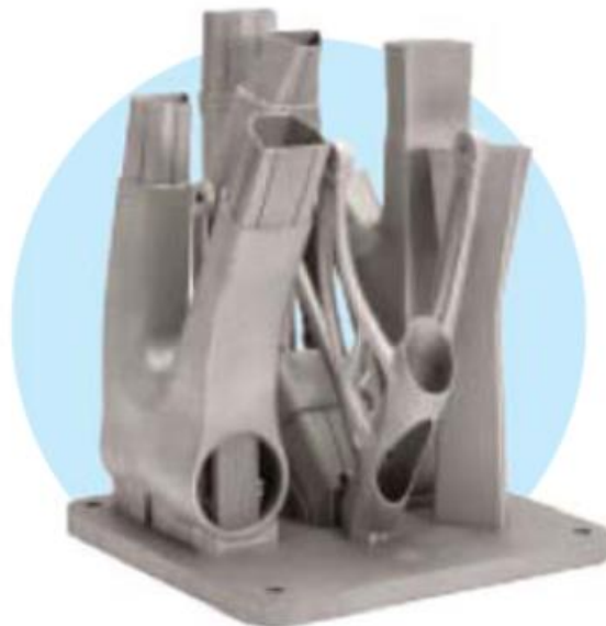
Рис. 1. Renishaw и Empire Cycles 3-D напечатали велосипедную раму из титана
