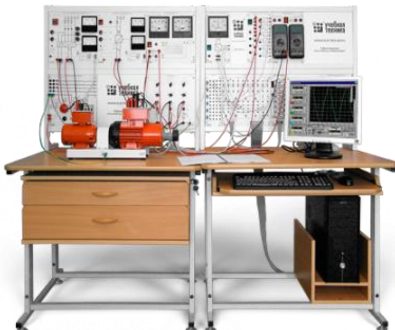
Рис. 1. Общий вид лабораторного стенда «Электромеханическая модель ветроэлектрогенератора» [3]
