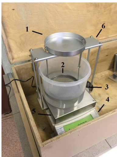
Рис. 1. Конструкция лабораторных весов ВЛЭ-1023С1 [6, С 1]
