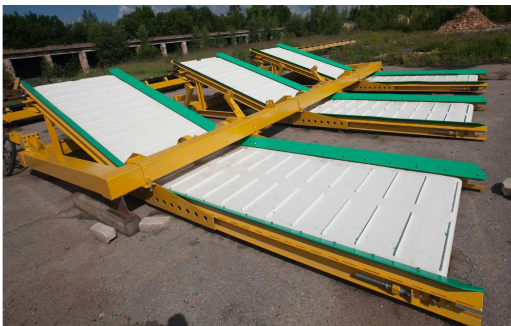
Рис. 15. Установка ленточного конвейера с подкатной тележкой
