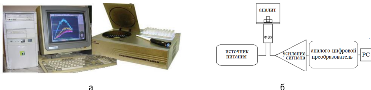
Рис. 1. Общий вид (а) и схема (б) автоматизированного комплекса для хемилюминесцентного анализа
