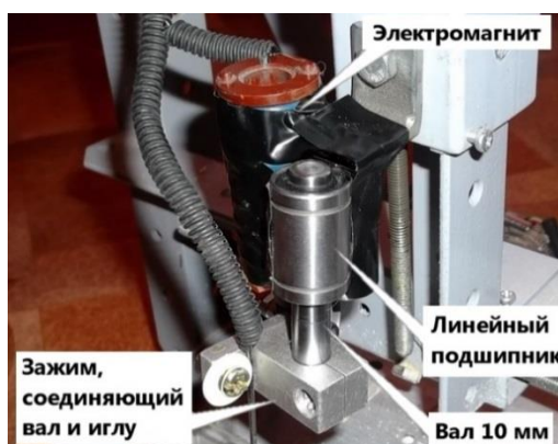
Рис. 1. Станок, работающий посредством электрохимической обработки
