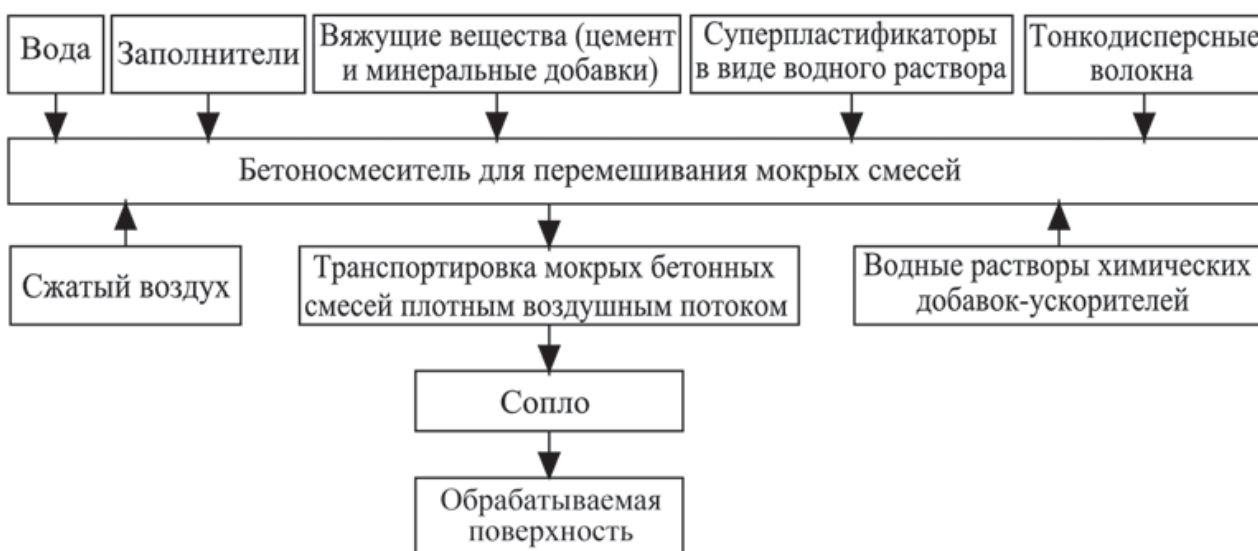
Рис. 3. Метод мокрого торкретирования
