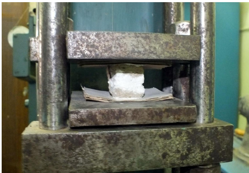
Рис. 4.3.9. Испытание образцов из раствора на сжатие
