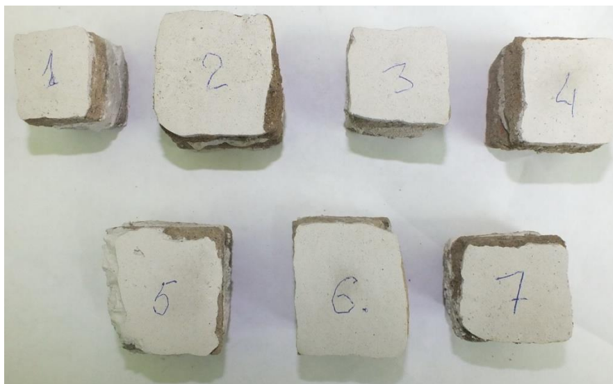
Рис. 4.3.8. Образцы из кладочного раствора в процессе подготовки к испытанию
