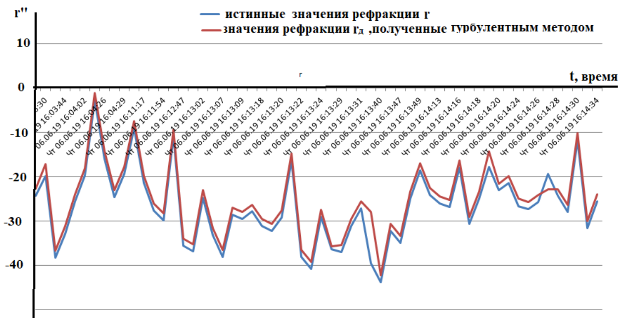
Рис. 2. Временной ход угла вертикальной рефракции \gamma_d , определённой при неустойчивой температурной стратификации на трассе протяжённостью 759,67 м с помощью тахеометра Trimble SX10 на [3]
