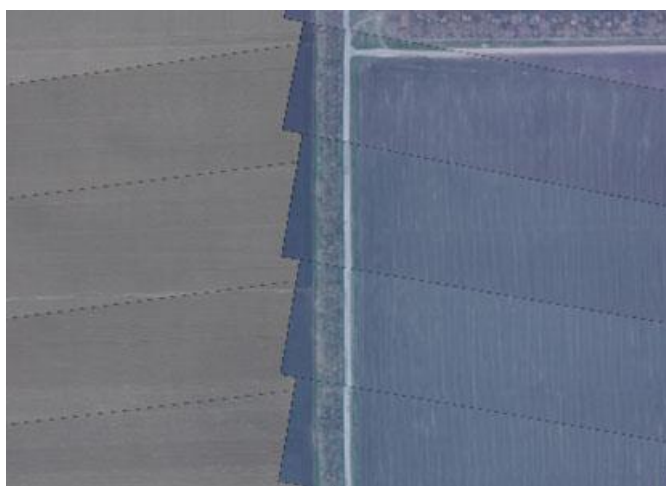
Рис. 4. Накидной монтаж после первых проходов автоматического измерения связующих точек
