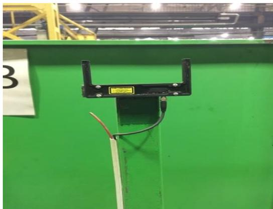
Рис. 4. Лазерный датчик дальномер
