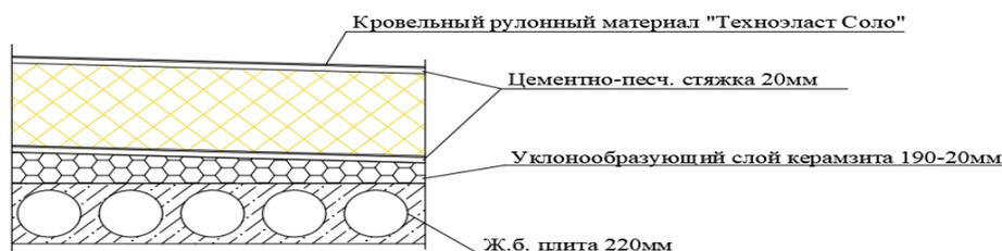
Рис. 1. Расчетная схема кровли
