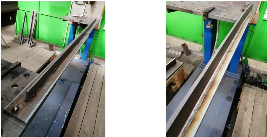
Рис. 5. Крупногабаритные образцы сварного шва длиной до 2м
