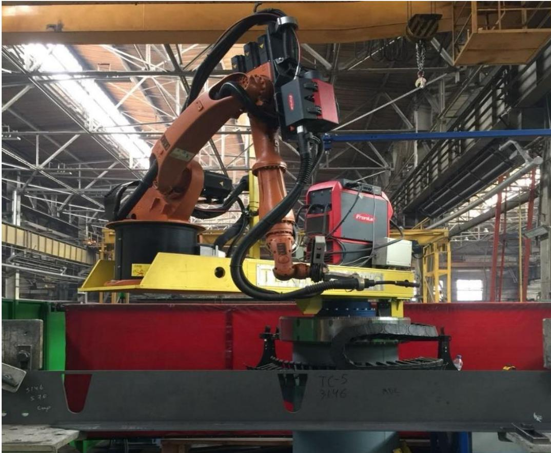
Рис. 1. Роботизированный сварочный комплекс на основе промышленного манипулятора Кука KR 16 L6-2
