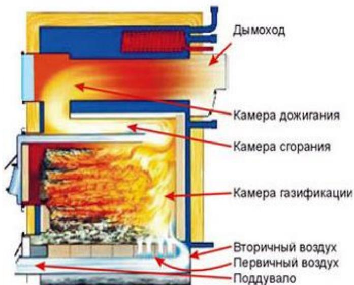
Рис. 2. Составные части пиролизного котла с естественной тягой
