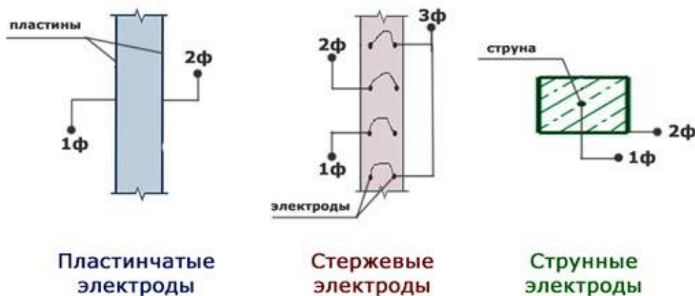
Рис.1. Прогрев бетона электродами
