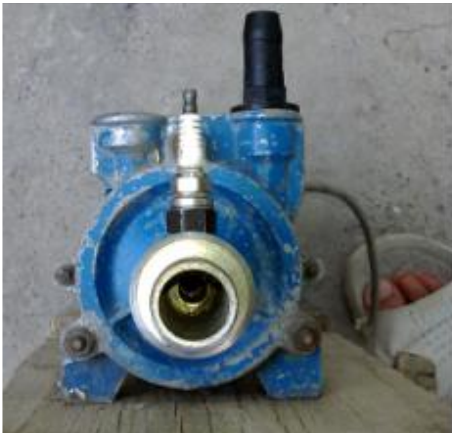
Рис. 3. Кавитационная установка с центробежным насосом
