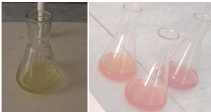
Рис.2. Фильтраты растворов до и после титрования раствором NaOH.
