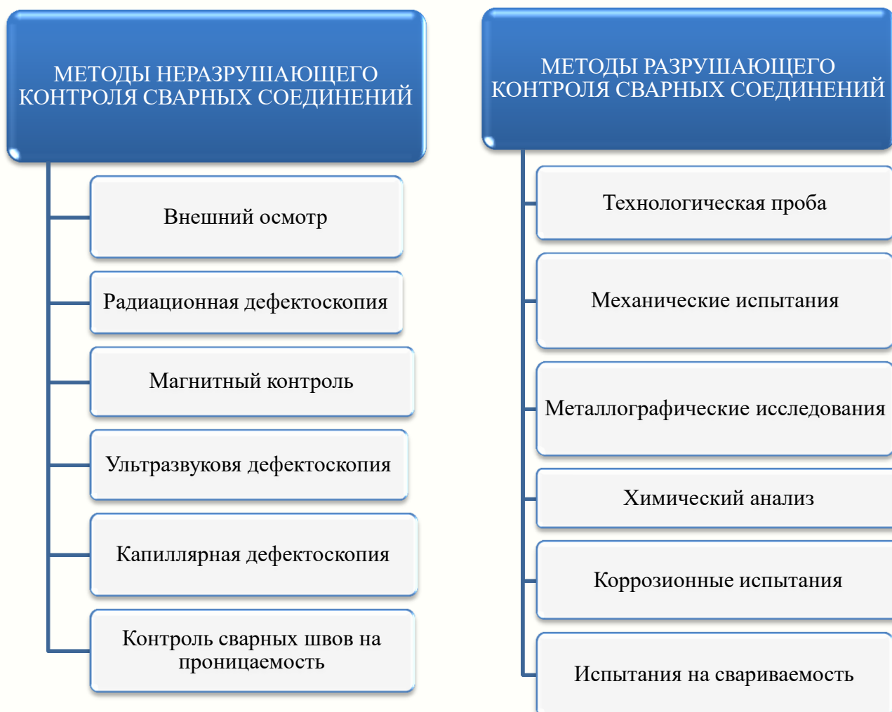
Рис. 2. Методы неразрушающего и разрушающего контролей сварных соединений
