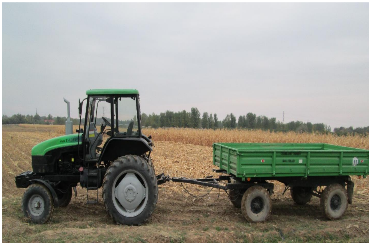
Рис. 1. Транспортный агрегат, составленный на базе трактора с регулируемым клиренсом ТТЗ-1033 и тракторного прицепа 2ПТС-4-793А
