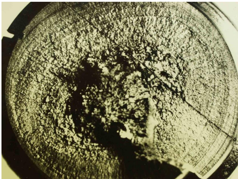
Рис. 3. Зона усталостного разрушения и хрупкого долома в центре сечения хвостовика двурогого крюка грузоподъемностью 40 т портального крана «Атлант», рег. № 51844-к
