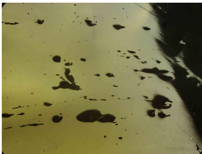
Рис. 4. Неметаллические включения в зоне хрупкого долома хвостовика двурогого крюка грузоподъемностью 40 т портального крана «Атлант», рег. № 51844-к (при 100-кратном увеличении)
