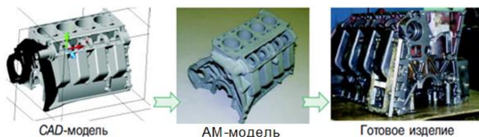
Рис. 3. Аддитивная технология на примере изготовления блока цилиндров автомобиля
