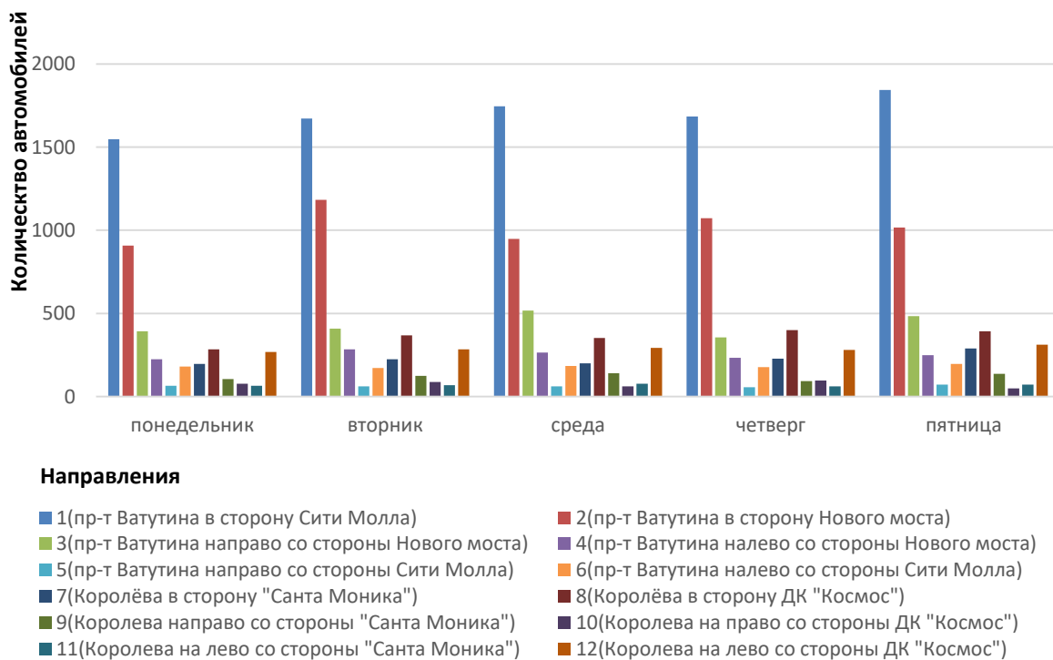
Рис. 2. Интенсивность движения транспортного потока на исследуемом перекрестке
