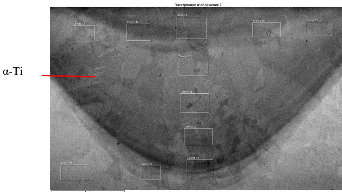
Рис. 4. Микроструктура металла наплавленного шва. Скорость подачи присадочной проволоки 1 м/мин, образец с 1 пазом
