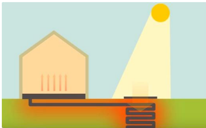
Рис.1 Устройство теплоаккумулятора под фундаментом дома
