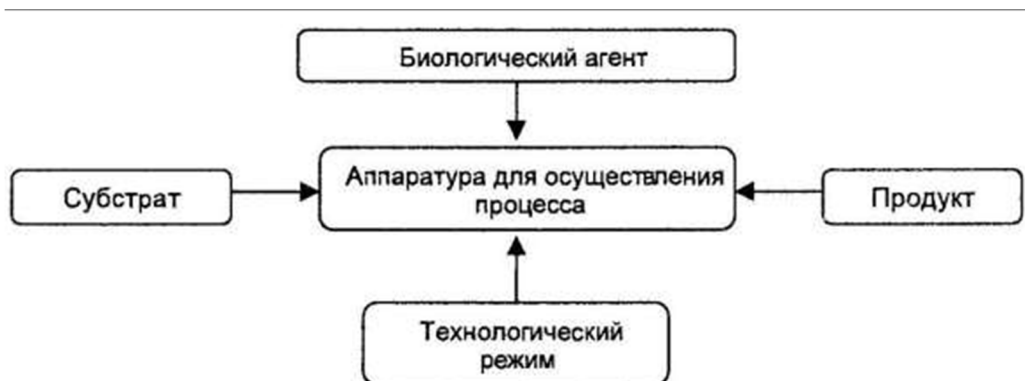
Рис. 1. Основные компоненты биотехнологической системы
