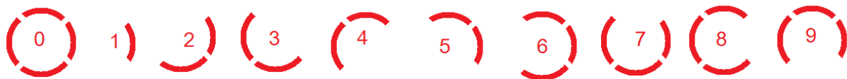
Рис.20. Формат индикатора в виде контура круга, представленного цифрой 0 и цифровые знаки на его основе.
