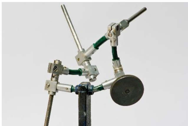
Рис. 2. Работоспособная модель четырехзвенного механизма Беннетта
