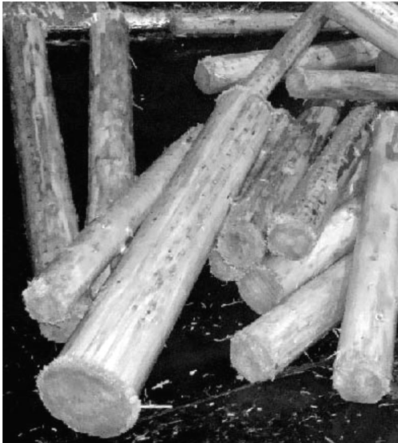
Рис. 1. Повреждение торцов балансов [5]
