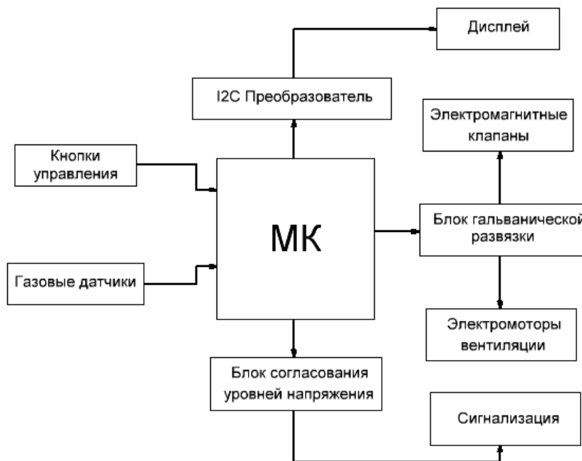
Рис. 2. Схема электрическая структурная устройства детектирования и предотвращения утечек взрывоопасных газов
