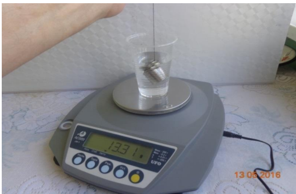
Рис. 4. Прямое измерение величины выталкивающей силы жидкости
