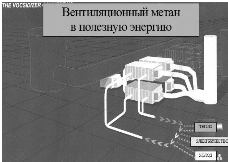
Рис. 1. Технология извлечения и использования вентиляционного метана
