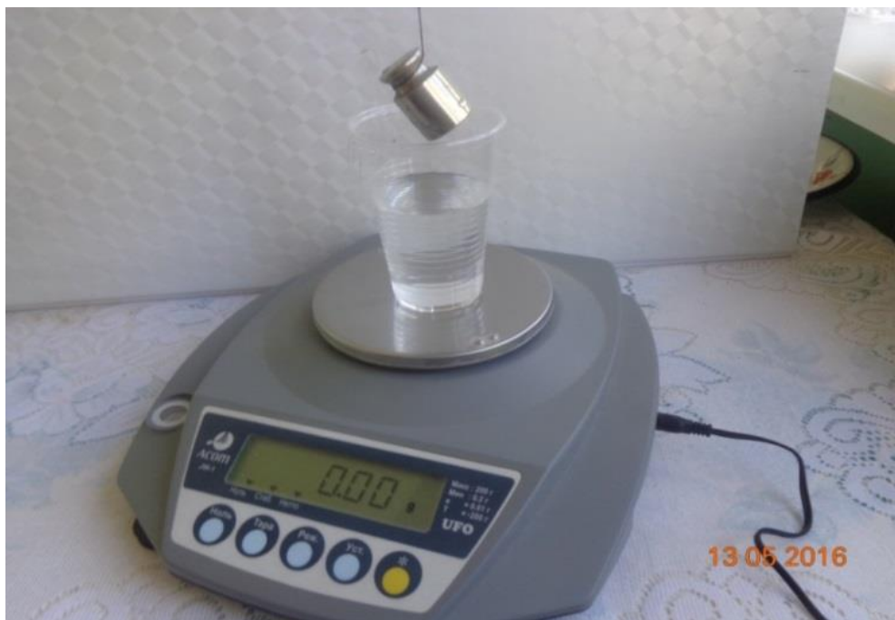
Рис.3. Обнуление весов перед измерением
