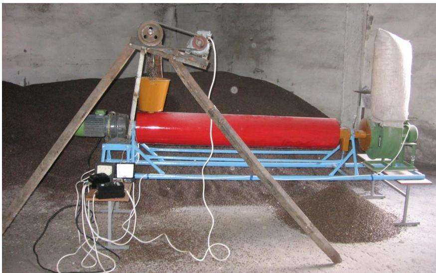
**Рис. 7 - Производственная мобильная зерносушилка**
