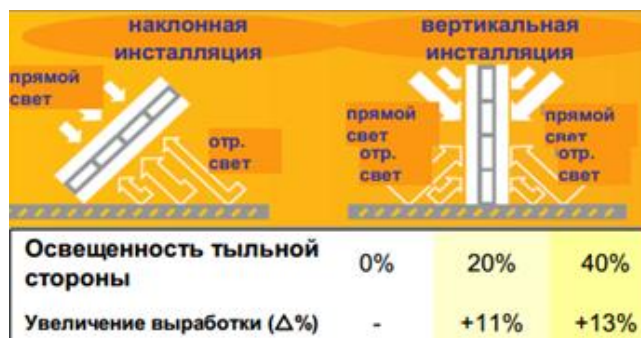
Рис. 1. Варианты установки двухсторонних СБ фирмы Suno и увеличение годовой выработки электроэнергии при различной освещенности тыльной стороны СБ
