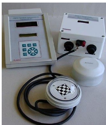
1 – табло; 2 – блок электронный; 3 – головка пиранометра
